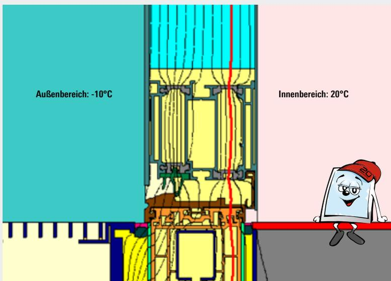
Aluminium ist ein guter Wärmeleiter. Um mit diesem Material eine hohe Wärmedämmung (kleine U-Werte) zu erreichen, haben die Konstrukteure der neuen Schüco ADS 75 SimplySmart Isolierstege integriert, welche für eine saubere thermische Trennung sorgen. (Siehe dazu auch Seite 32.)
